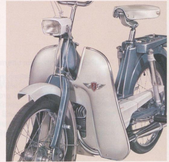
**Beherrschte Kraft:** Vibrationsfrei mit leisem Lauf und hervorragender Beschleunigung „flitzt“ dieser 50-ccm-Mofa-Motor von ZÜNDAPP. Der großflächig verrippte Alu-Zylinder, fahrtwindgekühlt, mit hartverchromter Lauffläche, garantiert lange Lebensdauer. Im Verbrauch ist er sehr sparsam.
